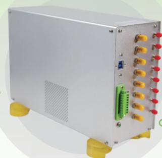
减震设计，机台运输时减少传感器震动损坏或失准，电磁屏蔽性能好，散热好
