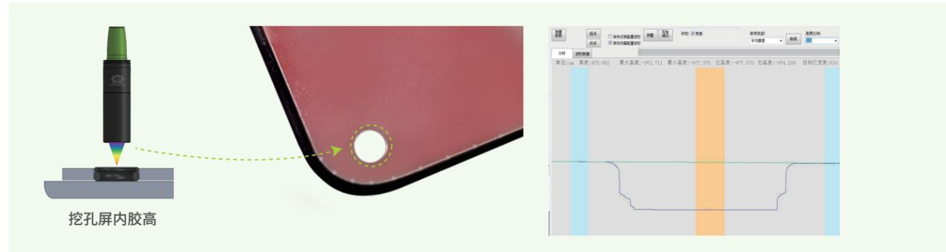
液体、透明胶水高度及轮廓测量
